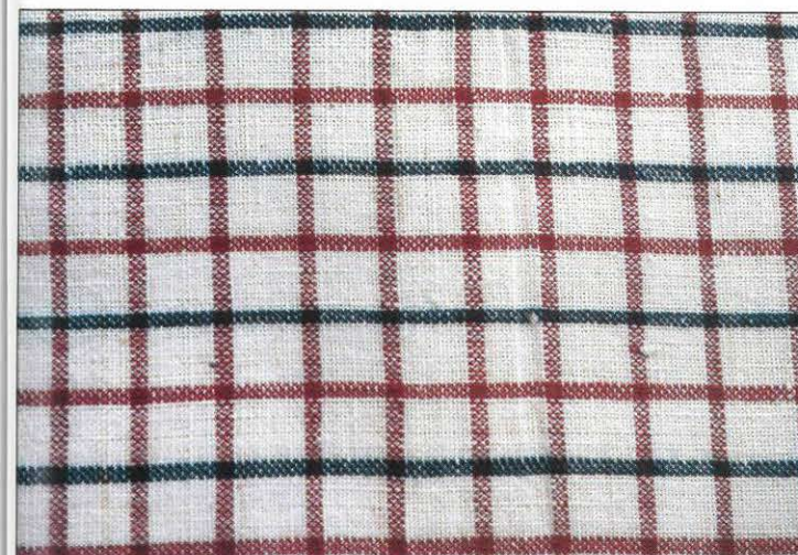
124-34 Αλατζιά σταυρωτή κοτσινούα με «διπλοτσιπαταλούθκια» (ρίγες διπλές) για σεντόνια χειμωνιάτικα, τραπεζομάντηλα και μαντηλιές (45X47 κλωστές / τετραγωνική ίντσα). Διαστάσεις: 25X42 εκ. Σύρμα: Βαμβακερό νήμα, 4 κόκκινο, 4 φυσικό χρώμα, 4 κόκκινο, 32 φυσικό χρώμα. Φάμμα: Βαμβακερό νήμα, 4 κόκκινο, 4 φυσικό χρώμα, 4 κόκκινο, 30 φυσικό χρώμα.
