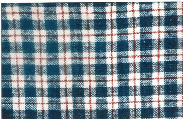
124-30 Αλατζιά σταυρωτή «καρωτούα» για τραπεζομάντηλα, μαντηλιές και πουκάμισα (50X48 κλωστές/τετραγωνική ίντσα). Διαστάσεις: 26X65 εκ. Σύρμα: Βαμβακερό νήμα 10 μπλε, 5 φυσικό χρώμα, 2 καμηλί (ταγκό), 5 φυσικό χρώμα. Φάμμα: Βαμβακερό νήμα 12 μπλε, 6 φυσικό χρώμα, 2 καμηλί (ταγκό), 6 φυσικό χρώμα.
