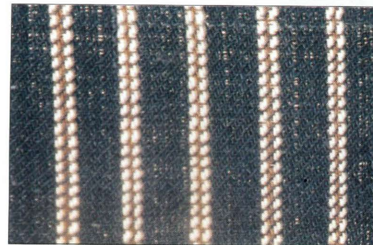
124-40 Αλατζιά δίμιτη φουστάνισιμη, παντελονίσιμη. (52X52 κλωστές / τετραγωνική ίντζα). Διαστάσεις: 27X49 εκ. Σύρμα: Βαμβακερό νήμα, 2 διπλές φυσικό χρώμα, 2 καφέ, 2 διπλές φυσικό χρώμα, 20 μπλε Φάμμα: Βαμβακερό νήμα μπλε.
