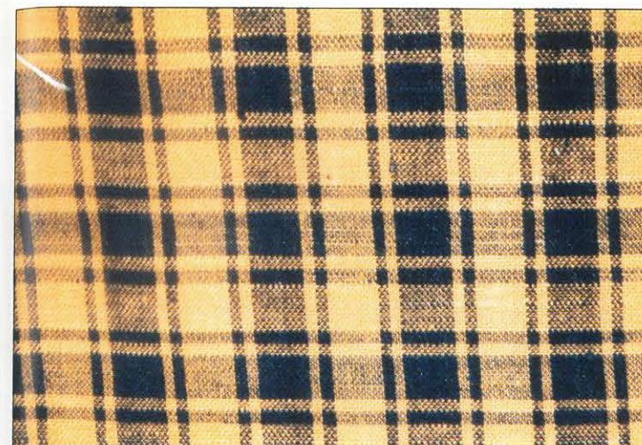
124-34 Αλατζιά σταυρωτή κοτσινούα με «διπλοτσιπαταλούθκια» (ρίγες διπλές) για σεντόνια χειμωνιάτικα, τραπεζομάντηλα και μαντηλιές (45X47 κλωστές / τετραγωνική ίντσα). Διαστάσεις: 25X42 εκ. Σύρμα: Βαμβακερό νήμα, 4 κόκκινο, 4 φυσικό χρώμα, 4 κόκκινο, 32 φυσικό χρώμα. Φάμμα: Βαμβακερό νήμα, 4 κόκκινο, 4 φυσικό χρώμα, 4 κόκκινο, 30 φυσικό χρώμα.
